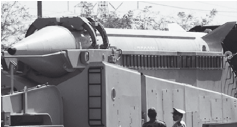
Ein auf der nordkoreanischen Rakete «Nodong» basierendes iranisches Derivat ist diese einstufige Mittelstreckenrakete des Typs «Shahab 3». Diese weist eine Reichweite von 1300 km auf, eine neue Variante «Shahab 4» soll gar 1900 km weit fliegen. Damit würde sie – dereinst möglicherweise mit einem Nukleargefchektskopf ausgerüstet – für Israel eine existenzielle Gefahr bedeuten.
